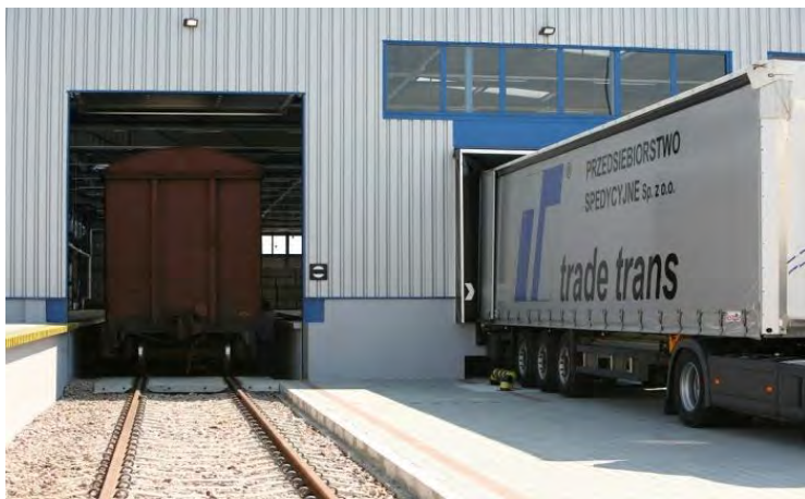
Entladung des Waggons mittels Stirnwand gleich dem Lkw-Trailer an der gleichen LKW Rampe
